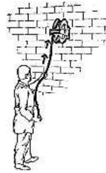
Шаг 3: После использования, идя к шланговой катушке. Оператор может намотать шланг, потянув за шланг, и фиксатор разблокирует механический замок.
