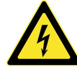
Peligro de descarga
