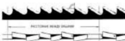
Еще одним преимуществом использования пильного полотна данного типа является то, что одним пильным полотном возможно разрезать заготовки разных размеров и типов. Комбинированные зубья:  $9^\circ - 10^\circ$  положительный уклон.
