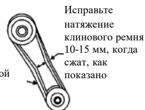
Рисунок 2. Натяжение клинового ремня
